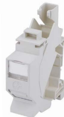
Statt eines Wandverteilers kann eine Gruppe Tragschienen-Verbinder, die jeweils ein RJ45-Modul enthalten, im Elektroverteiler montiert werden. Mit einer Breite von einer Teileinheit eignet sich der TS45 von Telegärtner hervorragend für die Hutschienenmontage im Elektroverteiler.
