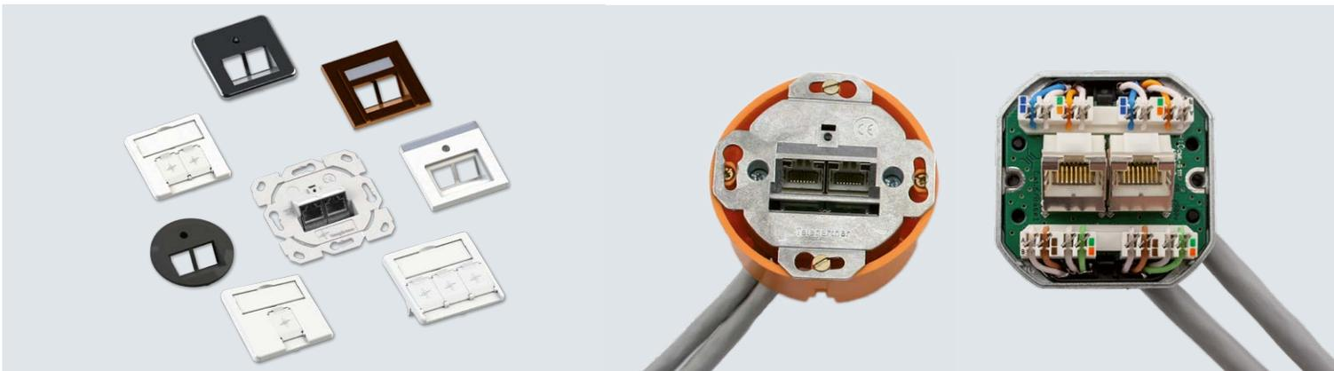
Designfähige Anschlussdosen wie die AMJ45 8/8 K Up/0 von Telegärtner lassen sich harmonisch in das vorhandene Schalterprogramm integrieren (links). Ihre flache Bauform, die in 45°-Schritten drehbare Kabelzuführung und die Beschaltung von vorne statt von hinten sorgen für kurze Kabelüberlängen und machen die AMJ45 zur perfekten Lösung bei Unter-Putz-Installationen (Mitte und rechts).
