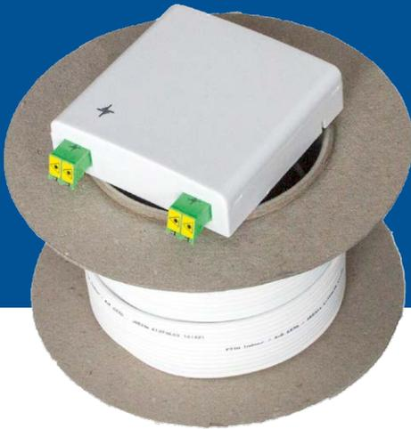
Besonders flache, unauffällige Glasfaseranschlussdose (Telegärtner OAD/F). Das dünne, flexible Glasfaserkabel ist dosenseitig mit Steckern versehen, die werksseitig bereits in die Kupplungen der Dose eingesteckt sind. Das Kabel gibt es ab Lager in Standardlängen, kann aber auch individuell metergenau bestellt werden. Die Pappspule kann nach der Installation umweltfreundlich entsorgt werden.
