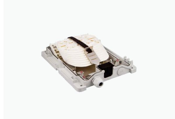
Beispiel für einen APL als Wandverteiler mit klappbaren Spleißkassetten: der ODB54 mit SAM-Spleißkassetten von Telegärtner. Der Deckel wurde für das Foto entfernt. Weitere Informationen in der Produktübersicht am Ende des Kapitels.
