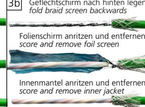
Folienschirm anritzen und entfernen score and remove foil screen
